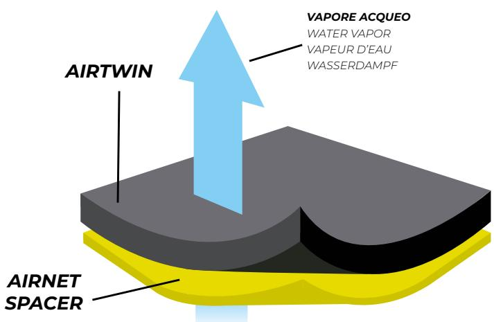
Tessuto tridimensionale, altamente traspirante, resistente all'abrasione e all'usura, garantisce un buon comfort ed un'elevata indemagliabilità.
